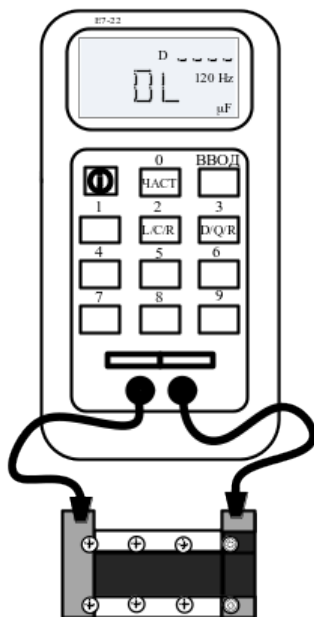
Рис. 1.6 - Соединение измерителя RLC и минимодуля «Диэлектрическая проницаемость»: 1 – кнопка выбора режима измерения основного параметра (емкость, индуктивность, сопротивление); 2 – кнопка включения прибора; 3 – кнопка выбора частоты тест сигнала; 4 – кнопка выбора режима измерения дополнительного параметра (активное сопротивление, добротность, диэлектрические потери).
